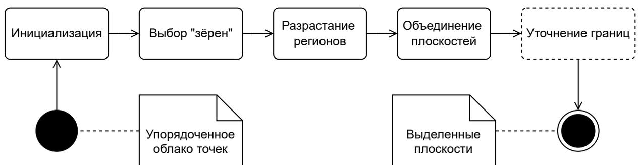
Рис. 2: Общая схема работы алгоритмов разрастания регионов
