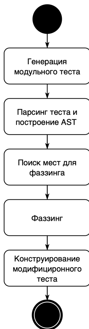
Рис. 1: Диаграмма активностей, отображающая процесс создания теста с модифицированными входными значениями
