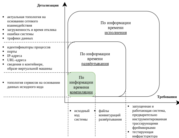
Рис. 6: Классификация средств визуализации микросервисов в соответствии с предъявляемыми требованиями и уровнем детализации
