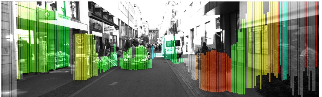
Рис. 5: Пример сегментации препятствий с помощью стикселей. Цветом закодировано расстояние.
