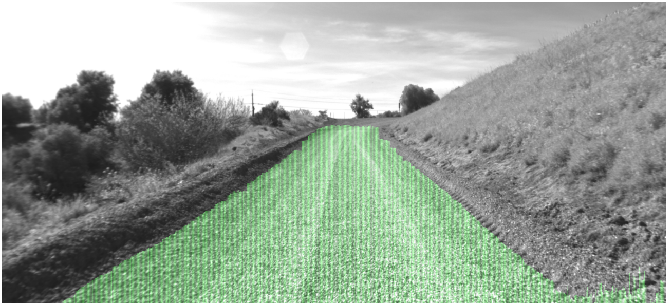
Рис. 7: Выделение области, безопасной для движения, с помощью сегментации согласно модели Stixel World.
