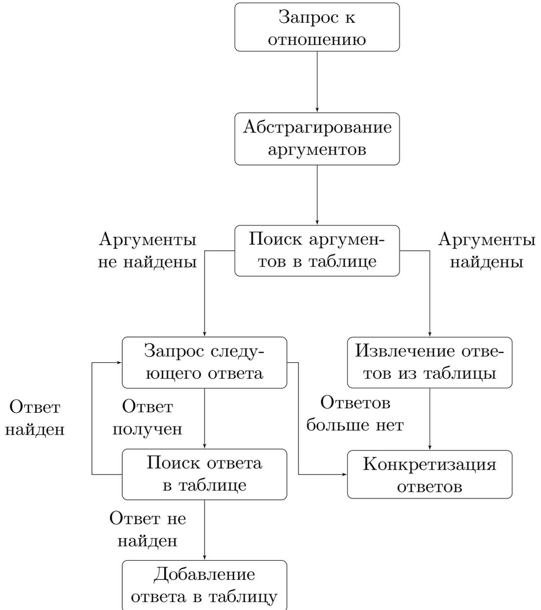
Рис. 8: Блок-схема алгоритма табличной мемоизации
