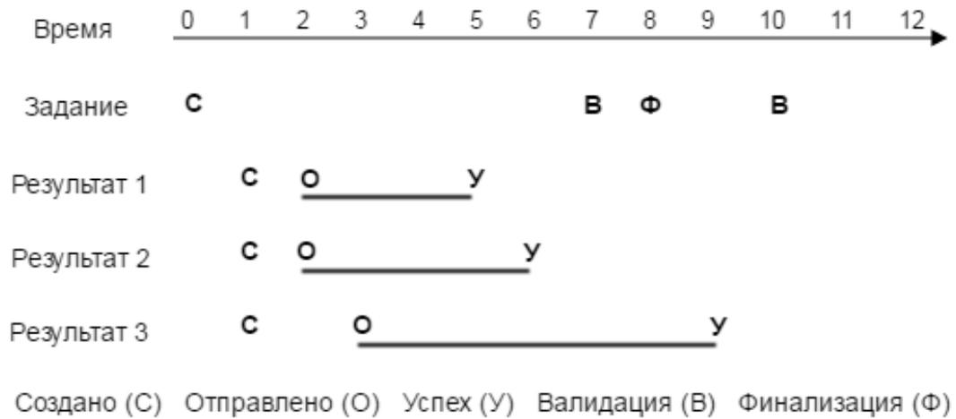
Рис. 3: Пример обработки задания
