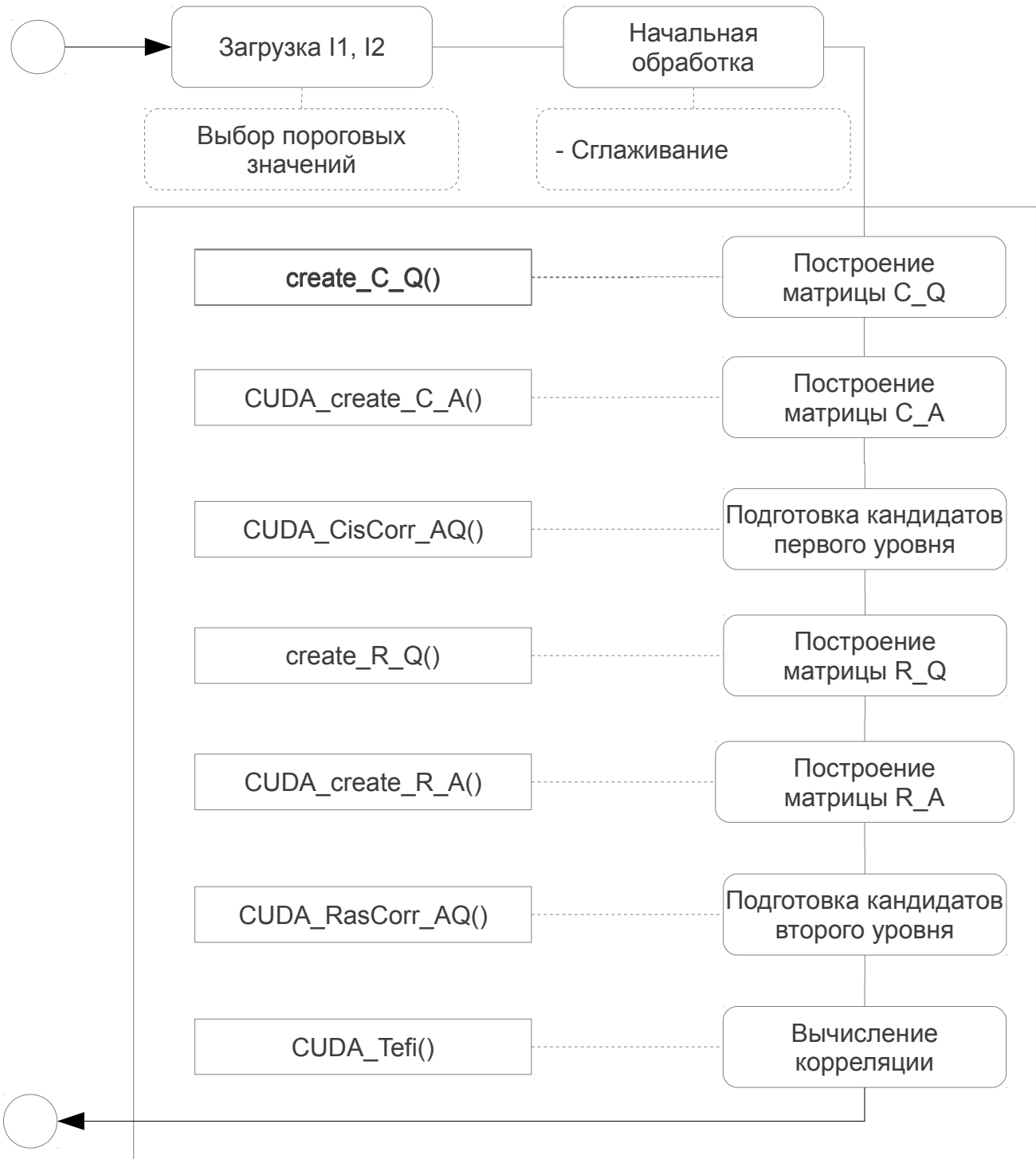
Рис. 4. Схема работы алгоритма Ciratefi
