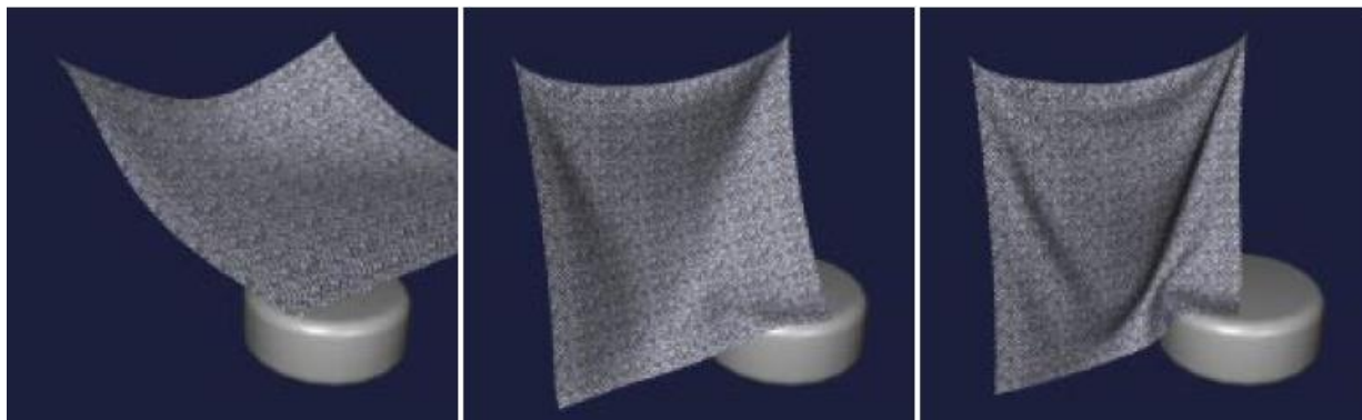
Рис.2. Моделирование ткани в методе Бараффа-Виткина (рисунок взят из [1]).
