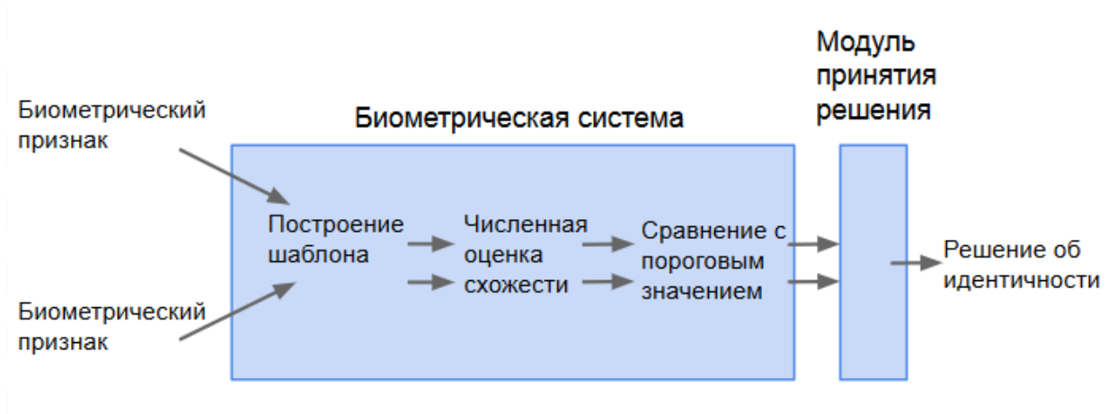
Рисунок 2. Схема мультимодальной системы, использующей 2 биометрических признака
