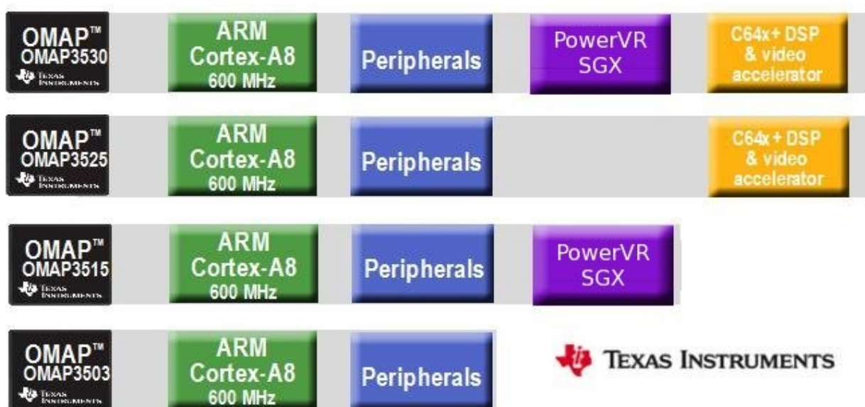
Рисунок 2: Линейка мультимедийных процессоров OMAP35xx
