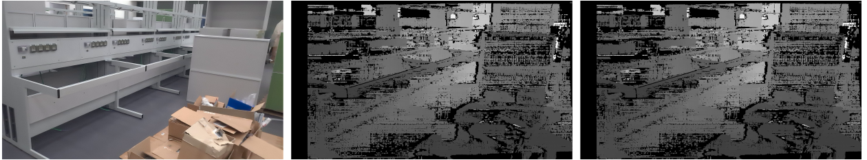
Рис. 1: Слева направо: изображение из стереопары (левое), карта глубины от оригинальной реализации, карта глубины от полученной реализации.
