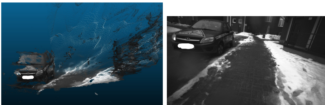
Рис. 6: Облако по стереопаре и правое изображение (номера автомобиля закрашены для данного отчёта). Пятна приводят к появлению несуществующих точек в воздухе
