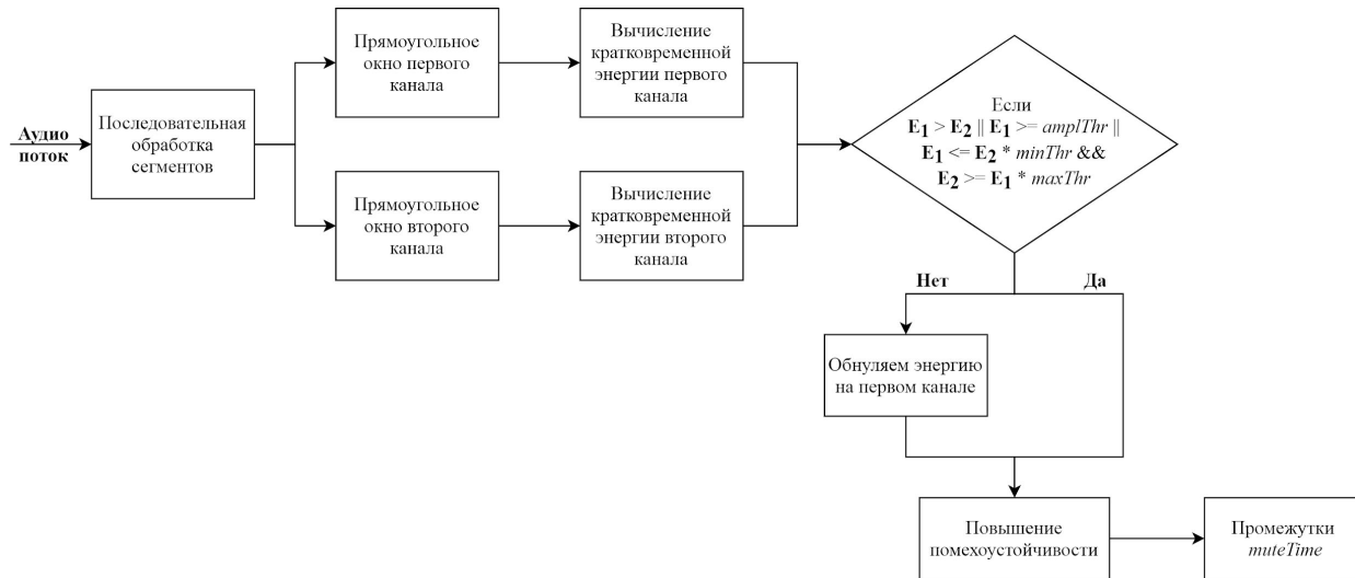
Рис. 5: Блок-схема работы алгоритма диаризации
