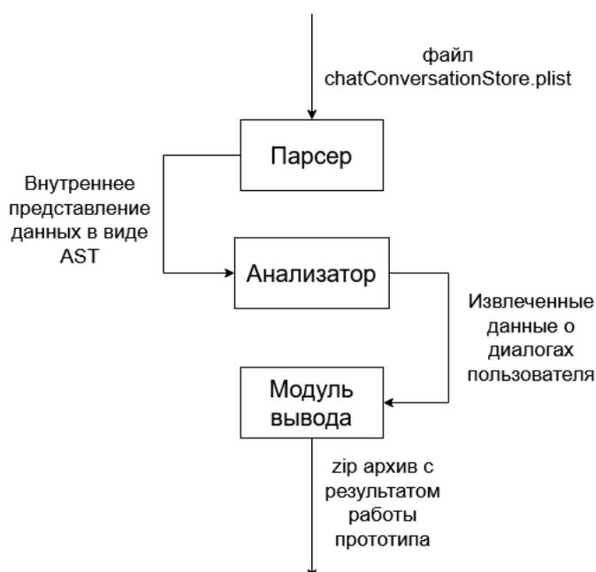
Рис. 7: Архитектура реализованного прототипа
