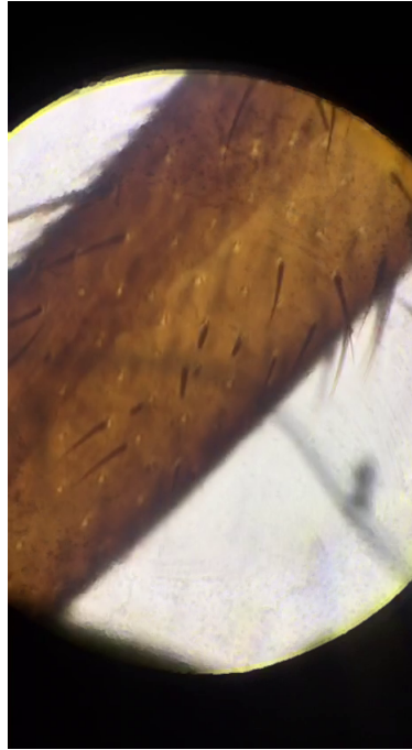
Рис. 6: Пример эффекта затемненных краев.
