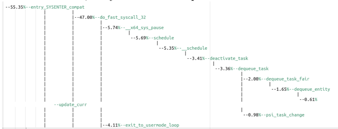
Рис. 5: Интересующая(верхняя) часть результата профилирования Embox на Linux, полученного на старте системы
