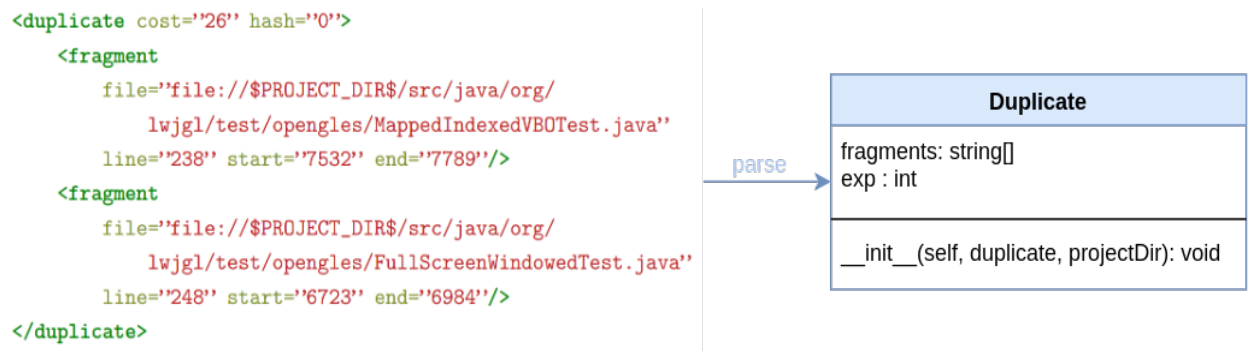
Рис. 5: Схема анализа XML файла дубликатов, fragments — дублирующиеся фрагменты кода, exp — флаг выделяемости в метод
