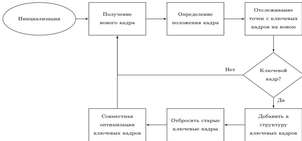
Рис. 7. Структура алгоритма одометрии
