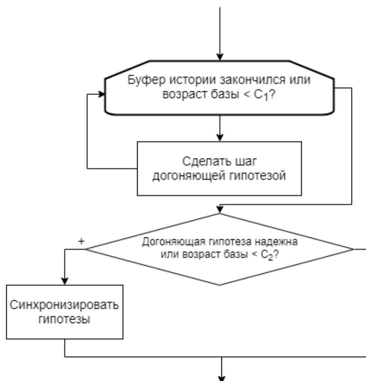
Рис. 8: Алгоритм работы догоняющего фильтра.
