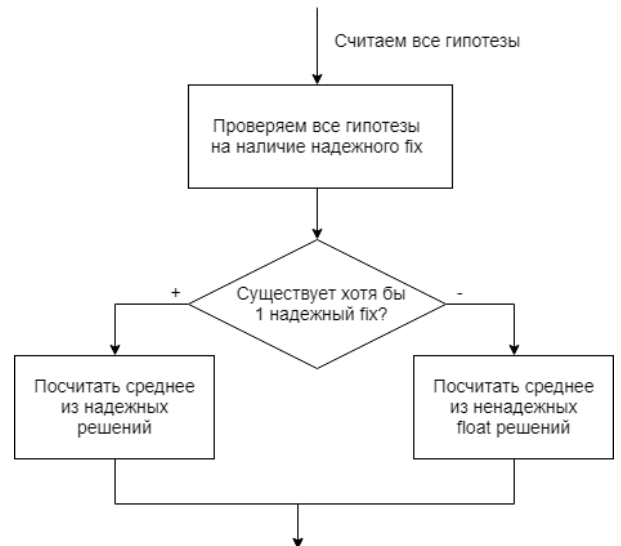
Рис. 5: Алгоритм работы фильтра.
