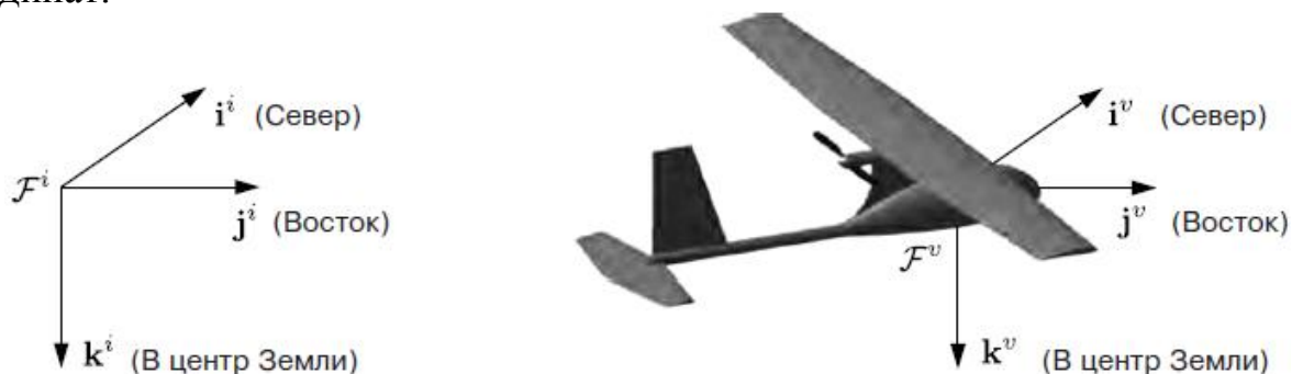
Рис 2: Система координат летательного аппарата
