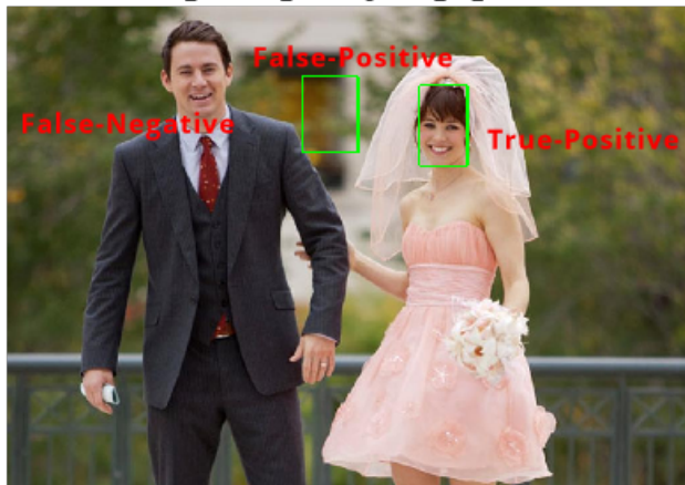
Рис. 3: True-Positive, False-Positive, False-Negative метки
