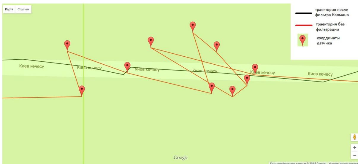
рисунок 3. Пример использования фильтра Калмана для сглаживания потока GPS координат.
