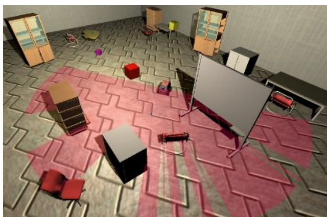
рис. 8. Morse. ATRV робот в замкнутом помещении.
