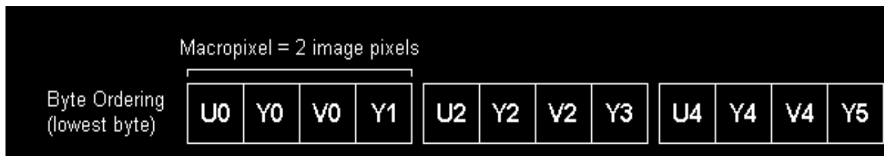
Рис. 2: Структура формата YUV422
