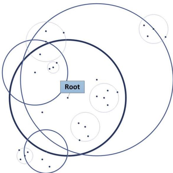
**BK-tree.** Древоподобная структура данных, строящаяся на элементах метрического пространства. Каждая вершина дерева содержит элемент метрического пространства, который уникально идентифицирует данную вершину, список дочерних узлов, где вставка элементов происходит следующим образом: если дерево пусто, то ставим корнем новый элемент, иначе рекурсивно находим расстояние  $R$  между данным словом и корнем текущего поддерева и вставляем этот элемент в поддерево с индексом  $R$ .
