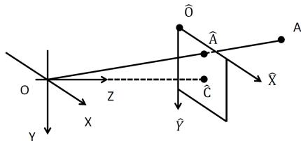
Спроектировать на камеру, установленную на высоте 1 м от поверхности земли и ориентированную так, что  $OY$  перпендикулярно поверхности, а  $OX$  параллельно горизонту с углом  $\theta_x = \theta_y = 60^\circ$  и размером матрицы  $600 \times 600$  пикс. точку, лежащую на поверхности земли влево от камеры на 1 м и впереди камеры на расстоянии 6 м.
