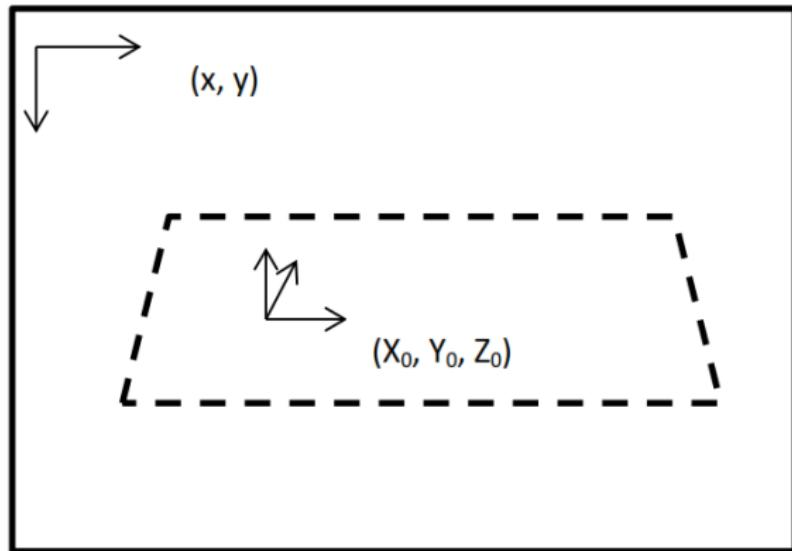
$$x \equiv K[r_1 \ r_2 \ r_3 \ t] \begin{pmatrix} X \\ Y \\ 0 \\ 1 \end{pmatrix} = K[r_1 \ r_2 \ t] \begin{pmatrix} X \\ Y \\ 1 \end{pmatrix}$$
